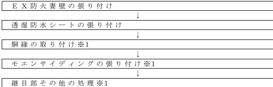
※ 下地組は、当防火認定の仕様に従ってください。当防火認定上、EX防火妻壁に横目地を設ける場合には、EX防火妻壁の横目地となる位置への屋外側受材(胴つなぎ)の取り付けは必須となります。
